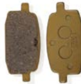
JUEGO BALATAS DELANTERAS DISCO Y BWS100 I WS150 TAIWAN
