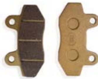
JUEGO BALATAS DELANTERAS DISCO ITALIKA DIABOLO TAIWAN
