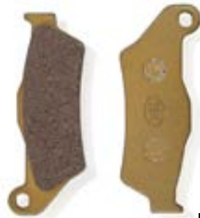
JUEGO BALATAS DELANTERAS DISCO Y FZ16 TAIWAN
